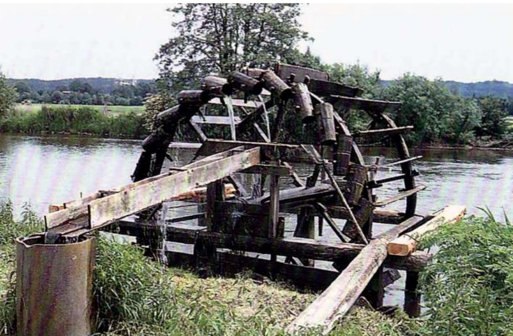
Nachbau „Kannenschöpfrad“ an der Regnitz (A. Hoffmann 2000, S. 38)
