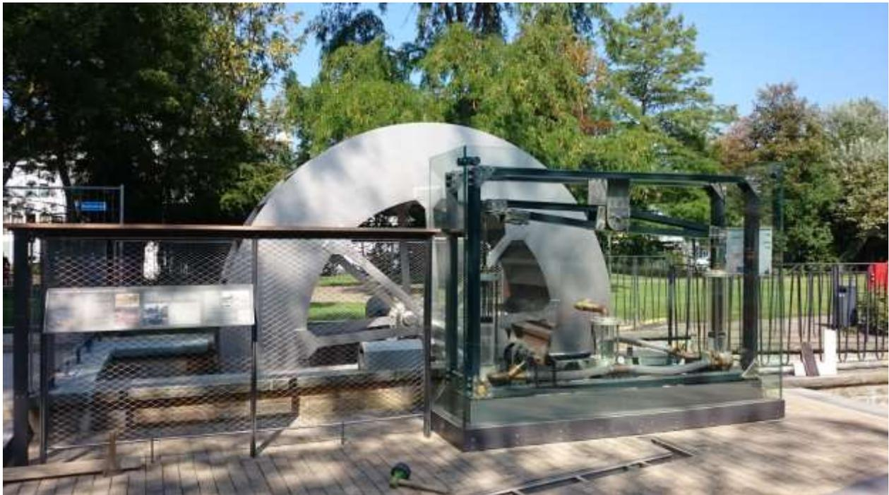
Das Rad treibt eine Zwei-Kolben-Pumpe mit einer maximalen Pumpleistung von 100 Litern pro Sekunde an. Dazu gehören ein Edelstahlrahmen und eine Einhausung mit Sicherheitsglas. Diese Pumpe wurde als Einzelstück von der Dreherei Wiechmann-Vieth aus Delbrück-Bentfeld hergestellt. Maßgeblich beteiligt an dem Paderfreunde-Projekt waren das Architekturbüro Völse aus Borchon und das Amt für Umweltschutz und Grünflächen der Stadt Paderborn.
